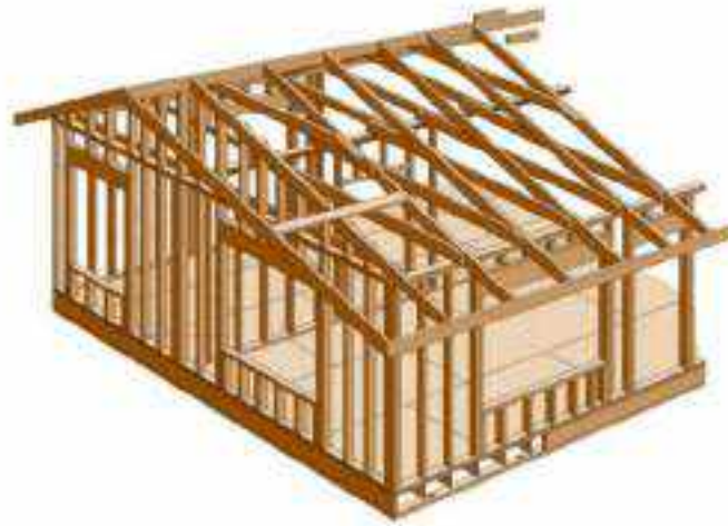
Gambar Il. 34 Semua komponen struktur kayu harus dirangkai, diangker, dikencangkan, dan dibuat kaku sehingga memiliki kekuatan dan kekakuan.
