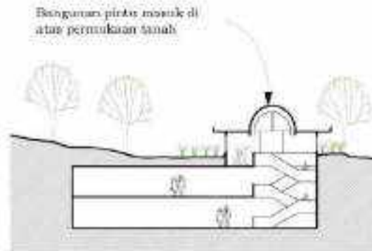
Gambar II.347 Contoh Bangunan Pintu-Masuk di Atas Permukaan Tanah
