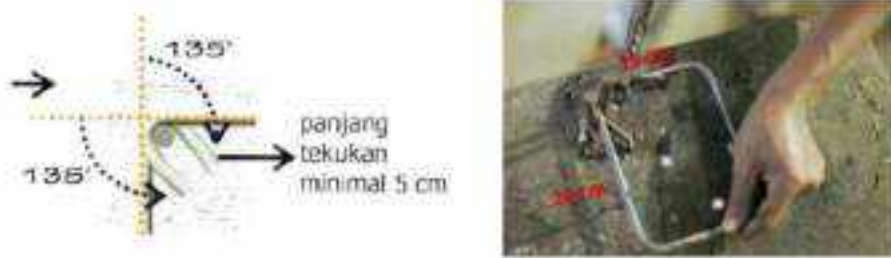
Gambar II.382 Tekukan Ujung Tulangan Begel
