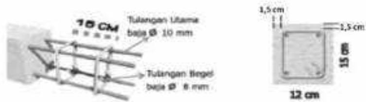
Gambar II.380 Dimensi Tulangan Balok Keliling/ Ring
