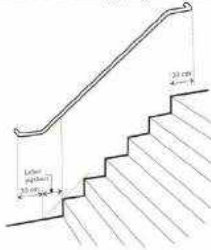
Gambar II.116. Detail tangga yang direkomendasikan
