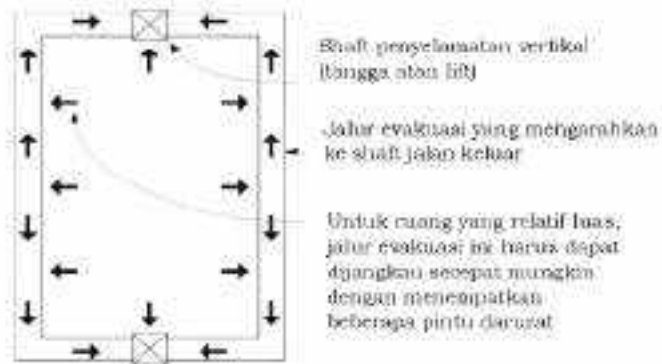
Gambar H.321 Contoh Jalur penyelamatan untuk ruang dalam bangunan yang relatif luas
