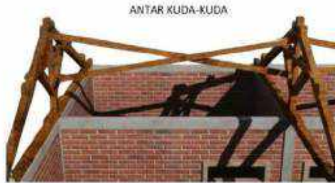
Gambar II.393 Ikatan Angin Sebagai Pengikat Antar Kuda-Kuda Kayu
