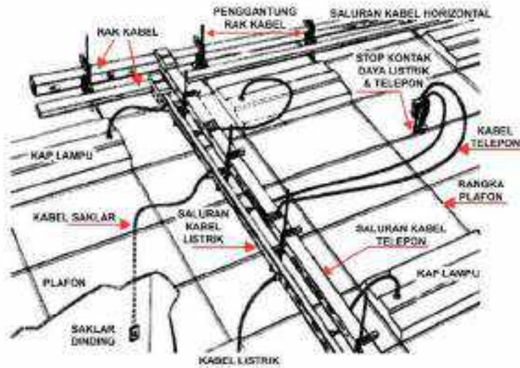
Gambar II. 41 Instalasi kabel di atas plafon dipasang dengan baik
