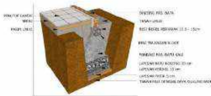
Gambar II. 25 Material alas pondasi yang digunakan berupa satu lapis pasangan batu kosong; batu kerikil, dan pasir/lantai kerja agar dapat meratakan beban ke lapisan tanah keras.
