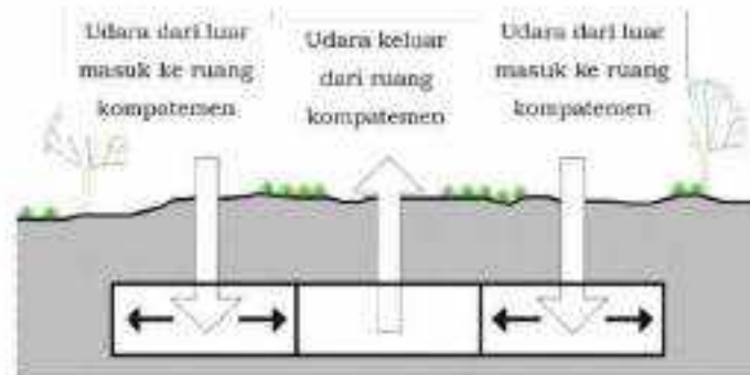
Gambar II.327 Contoh Sistem Mekanikal Bangunan Bawah Tanah
