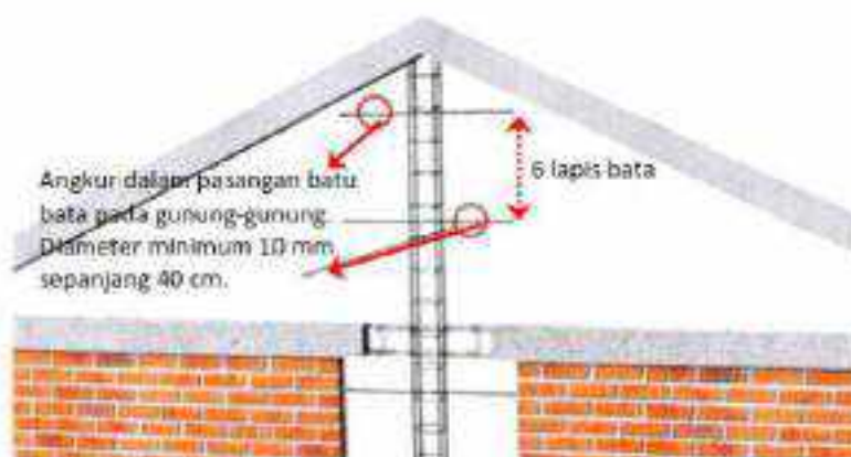
Gambar [L.411] Hukungan Angkur Pada Gunung-Gunung/ Angkur
