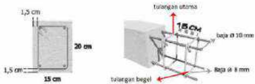
Gambar II.377 Dimensi Tulangan Balok Pengikat/ Sloof
