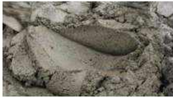
Gambar II.368 Hasil Pencampuran Mortar Yang Baik
