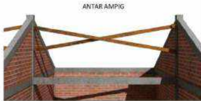
Gambar II.394 Ikatan Angin Sebagai Pengikat Antar Gunung-Gunung/ Ampig
