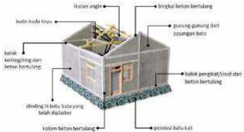
Gambar II.360 Struktur Bangunan Rumah Tinggal Tunggal
