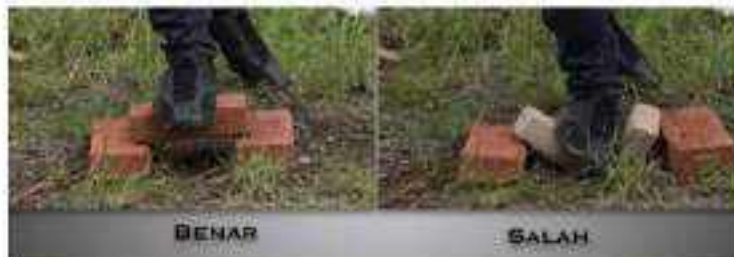
Gambar II.372 Pengujian Sederhana Kekuatan Batu Bata
