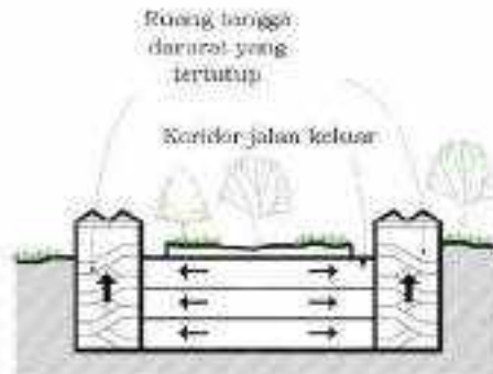
Gambar B.320 Contoh Jalur Penyelamatan Untuk Bangunan
