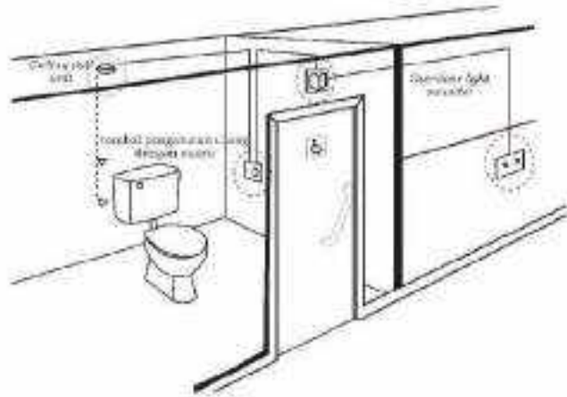
Gambar II.205. Mekanisme push button pada toilet penyandang disabilitas
