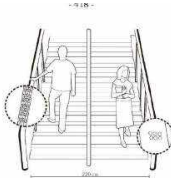
Gambar II.124. Tangga yang dilengkapi dengan huruf braille di sisi atas pegangan rambatan pada interval tertentu yang menunjukkan posisi anak tangga.
