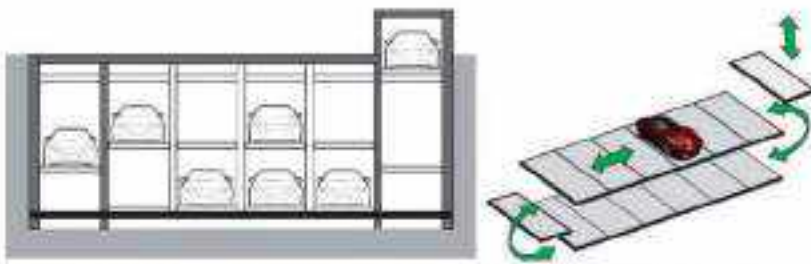
Gambar II.272 Contoh tipe parkir vertikal pada UD Type convey Parking dengan akses langsung
