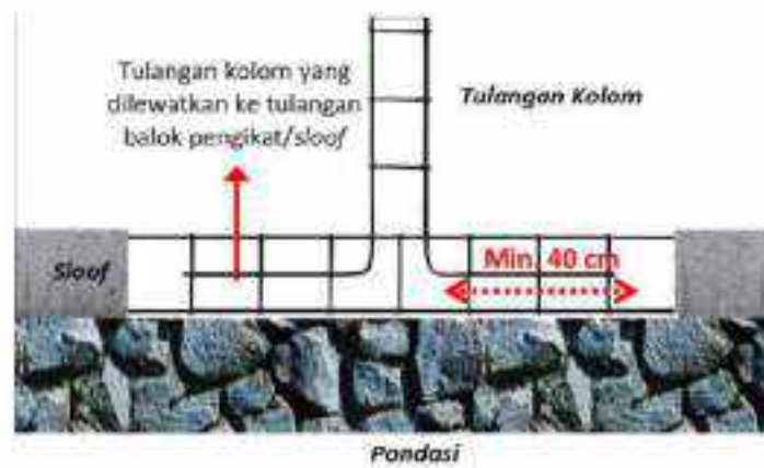
Gambar II.404 Detail Hubungan Balok Pengikat/Sloof dengan Kolom
